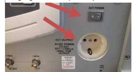
Figuur 1: hoofdschakelaar van de Surge generator (links op het
