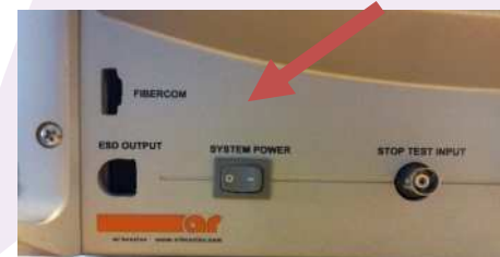
Figuur 1: hoofdschakelaar van de Surge generator (links op het
