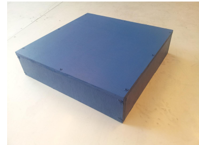
Figuur 1: Het houten kistje van 10cm hoog. De EUT komt hier op te staan.
