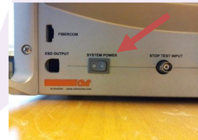
Figuur 2: De hoofdschakelaar van de surge generator aan de linker kant van het apparaat.
