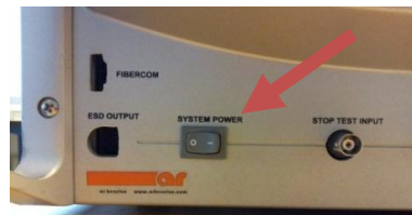
Figuur 2: De hoofdschakelaar van de surge generator aan de linker kant van het apparaat.
