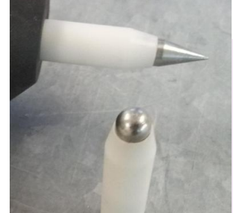
Figuur 3: ESD opzetstukken, ook wel tip genoemd.
