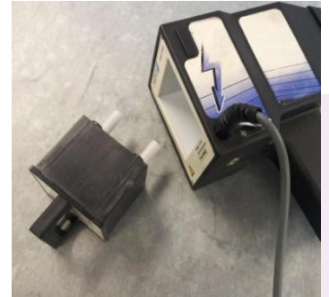
Figuur 6: wijzigen van polariteit ESD gun
