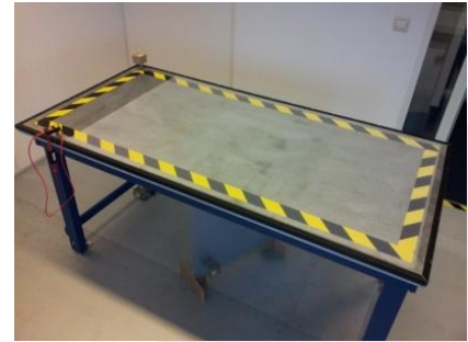
Figuur 1: ESD tafel met markeringen en plastic isolatiesheet
