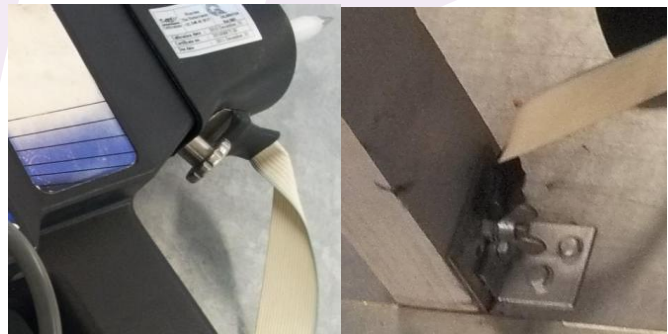
Figuur 2: discharge return cable aan ESD gun en tafel
