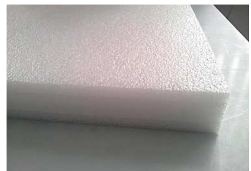
Figuur 2: polyethyleen isolator voor verhoging van VP_{EUT}
