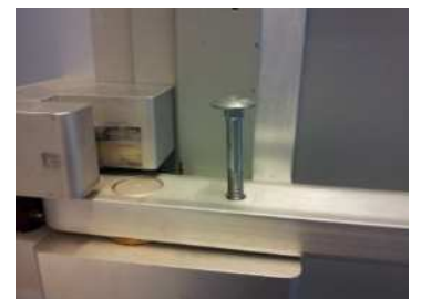
Figuur 5: pin voor GTEM deur
