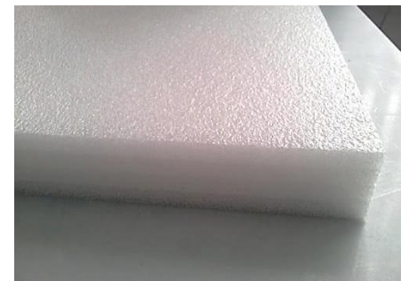
Figuur 2: polyethyleen isolator voor verhoging van VP_{EUT}
