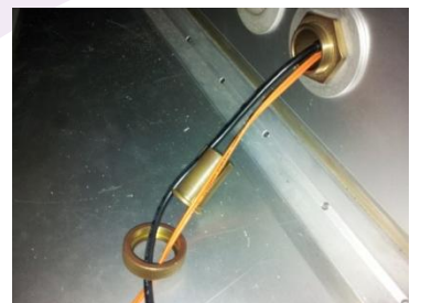
Figuur 3: Geleiding van de kabels in de GTEM.
