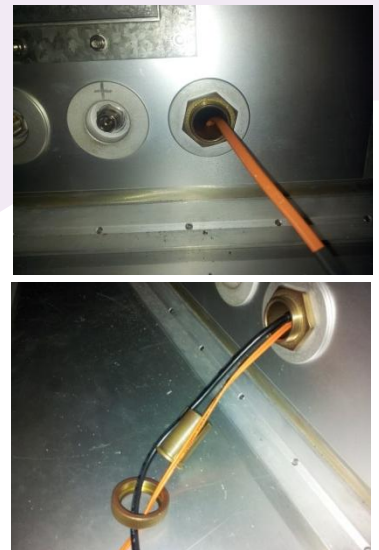
Figuur 3: geleiding van de kabels in de GTEM.
