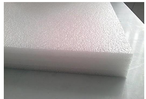
Figuur 2: polyethyleen isolator voor verhoging van VP_{EUT}
